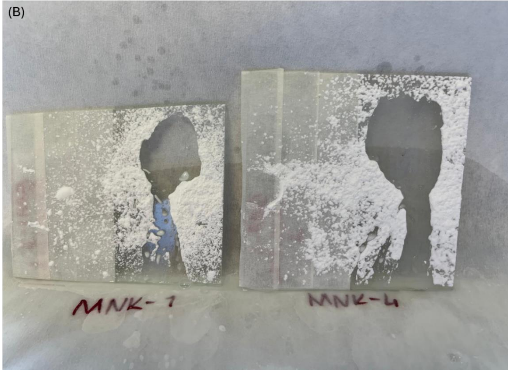
Şekil 4.68.: A- MNK-1 ve MNK-4 kaplamalarının kirletilmiş yüzey görüntüsü, B- MNK-1 ve MNK-4 kaplamalarının kendini temizleme etkisi
