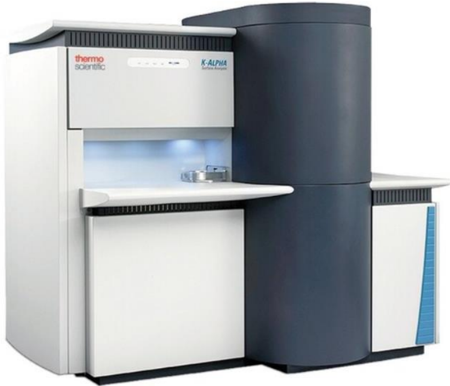
Şekil 3.7.: XPS analizi için kullanılan Thermo Scientific K-Alpha, ABD cihazı
