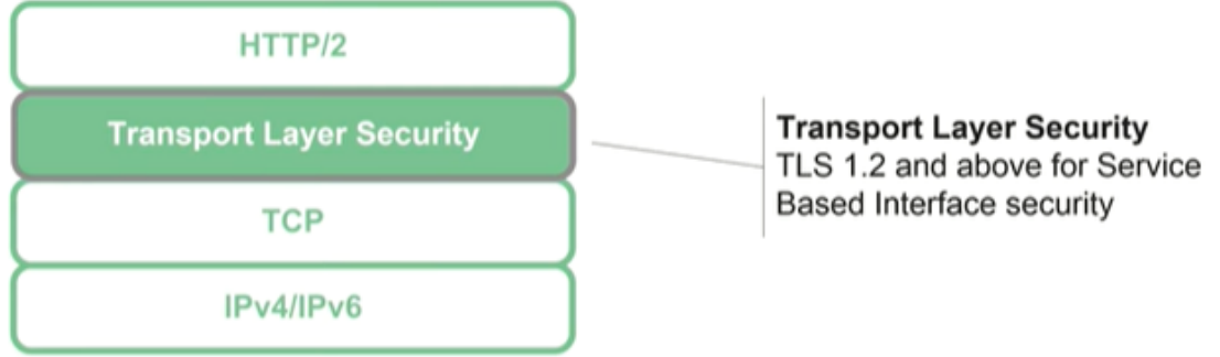
Şekil 1.28: 5G’de Hizmet Tabanlı Arayüzleri Koruma
