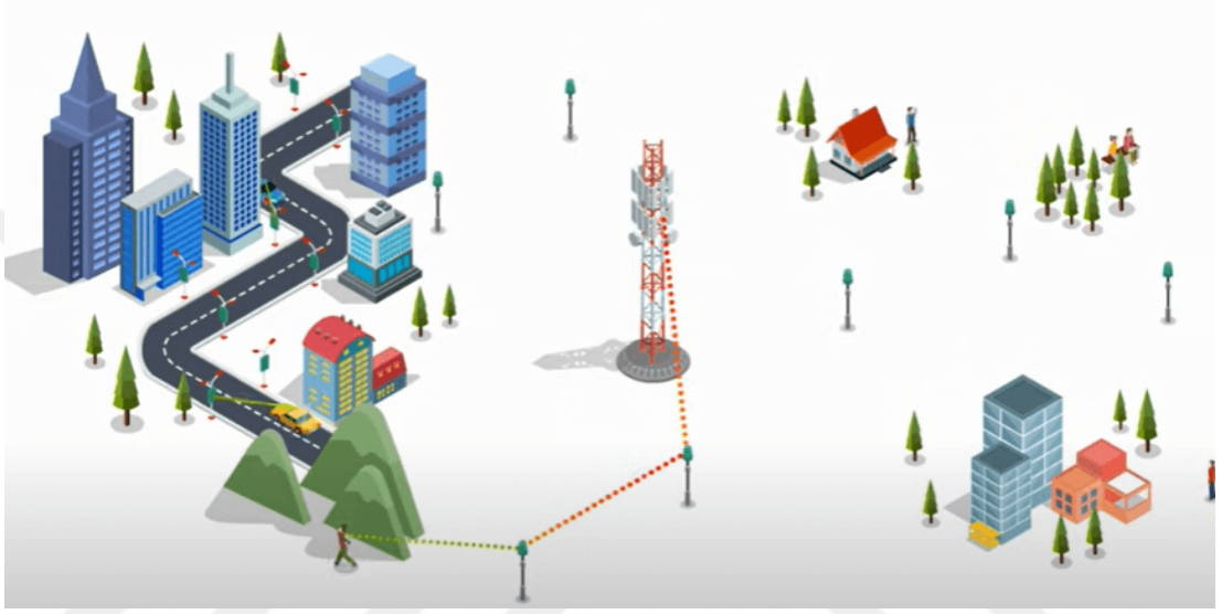
Şekil 1.15: Küçük Hücrelerle 5G Hücresel Ağlarında Bağlantının Sağlanması
