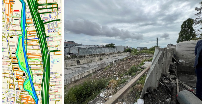
Şekil 6.20: Ayamama Deresi akış güzergahlarının düzleştirildiği ve değiştirildiği bölgeler
