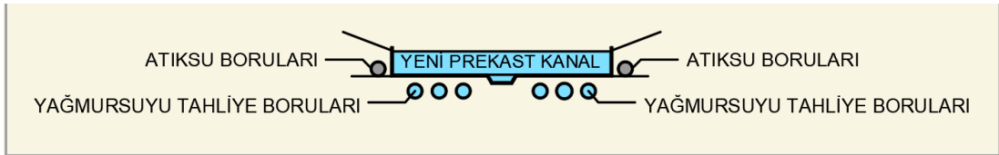
Şekil 6.10: Yağmursuyu ve Atıksu Tahliye Boruları
