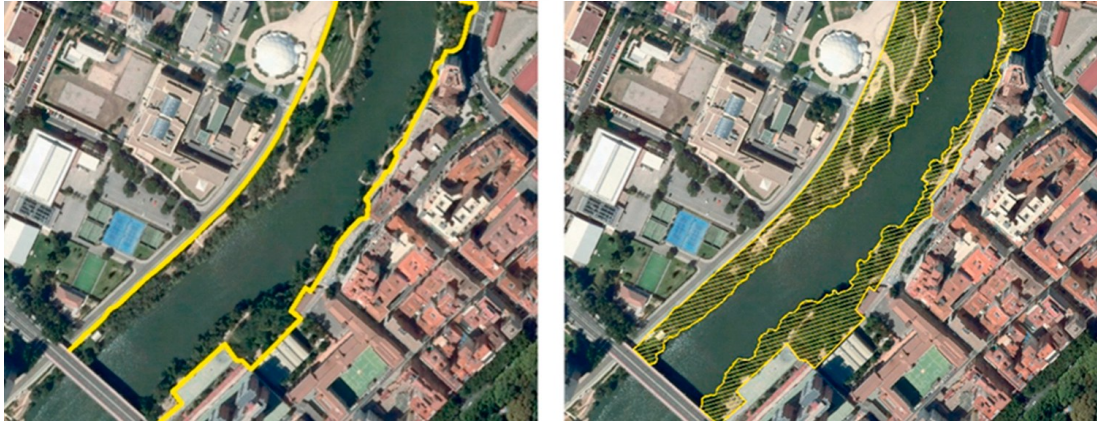
Şekil 4.27: Su yolu kenarlarının önceki ve sonraki yorumu
