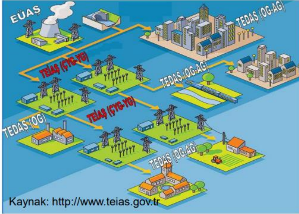
Şekil 1.1: Elektrik Üretim, İletim ve Dağıtım
