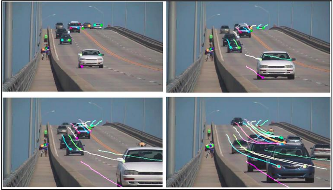
Şekil 4.5: Lukas-Kanade yöntemi uygulanmış görseller.
