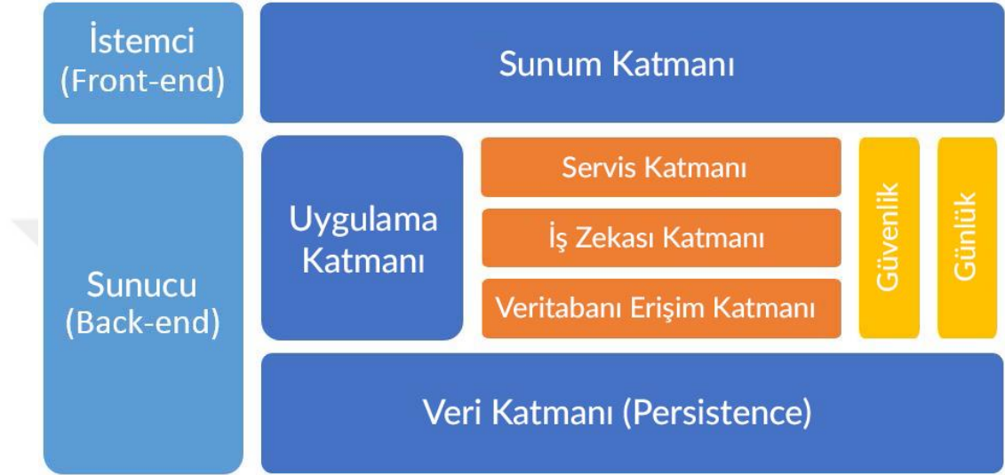
Şekil 1.3: İstemci ve sunucu (Client/Server) ayrımını katmanlara göre gösteren çok katmanlı bir mimari.
