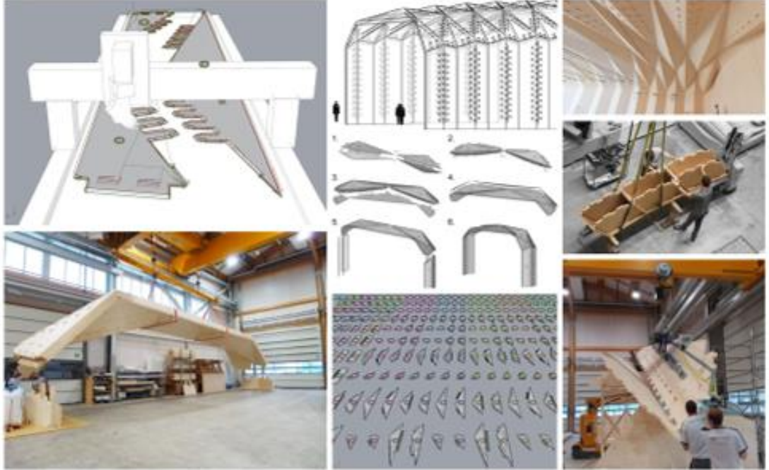
Şekil Ek 5: Deneysel bir çalışma olarak bir CLT katlanmış plağın tasarım, prefabrikasyon ve kurulumuna yönelik süreç.
