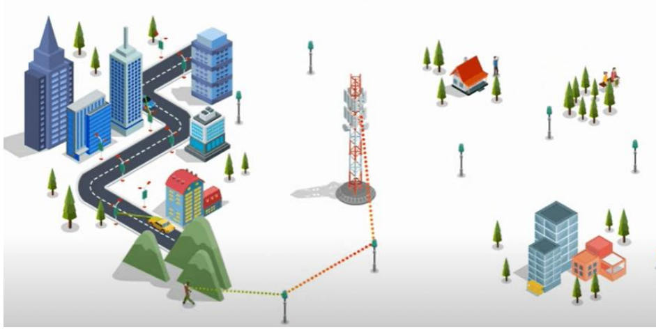
Şekil 1.8: Küçük Hücrelerle 5G Hücresel Ağlarında Bağlantının Sağlanması Kaynak: Sunny Classroom.
