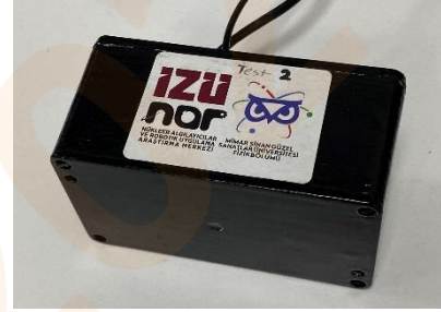
Fig. 2. Yarı iletken foto-çoğaltıcı ile LYSO kristalinin birleştirilip, ön yükselteç devresi üzerinden çıkış alacak ve besleme girişleri bulunacak şekilde ışık geçirmez bir kutuya yerleştirilmiş dedektör.
