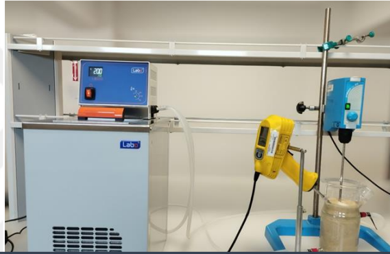
US 1 ve US 2 uygulamasında sirkülasyonlu su sistemi ile sıcaklığın 20°C’de sabit tutulması
