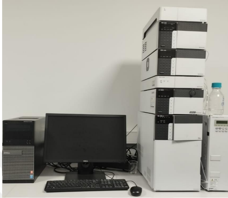
Şekil 3.11: Ruşeym protein hidrolizatlarının şeker ve serbest amino asit analizlerinin ölçümünde kullanılan HPLC sistemi
