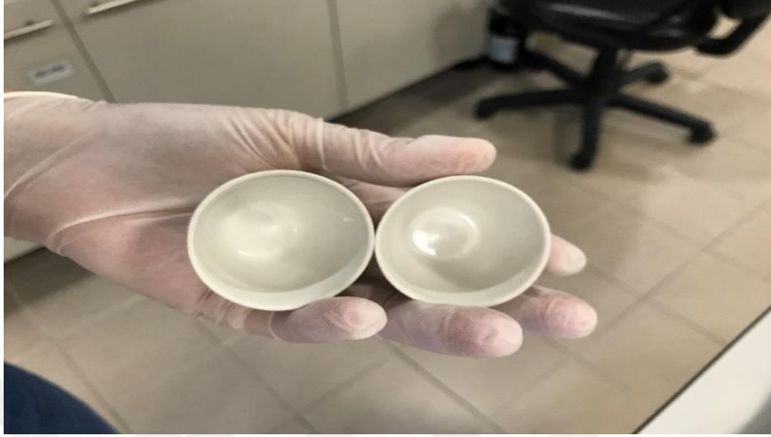
Şekil 4.23: Kül analizi sonunda fırından alından numuneler.
