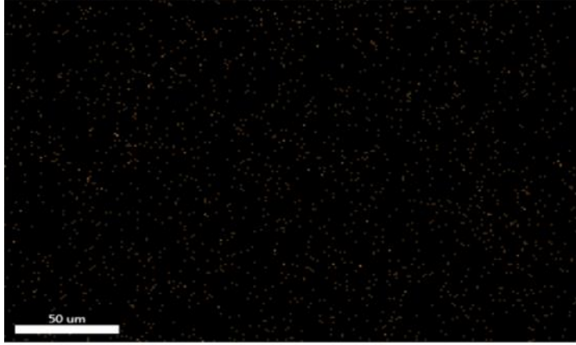
Şekil 4.16: HKN film numunesindeki Na (sodyum) elementinin dağılımı
