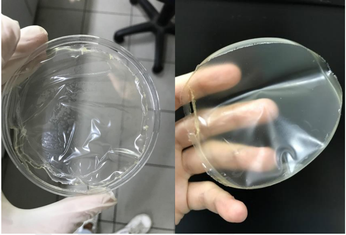
Şekil 4.2: Yenilebilir filmlerin renkleri; en incisi (10 mL) ve en kalını (40 mL)
