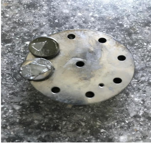
Şekil 3.3: Altın-paladyum (Au/Pd) ile kaplanmış HKN ve OKN film numuneleri
