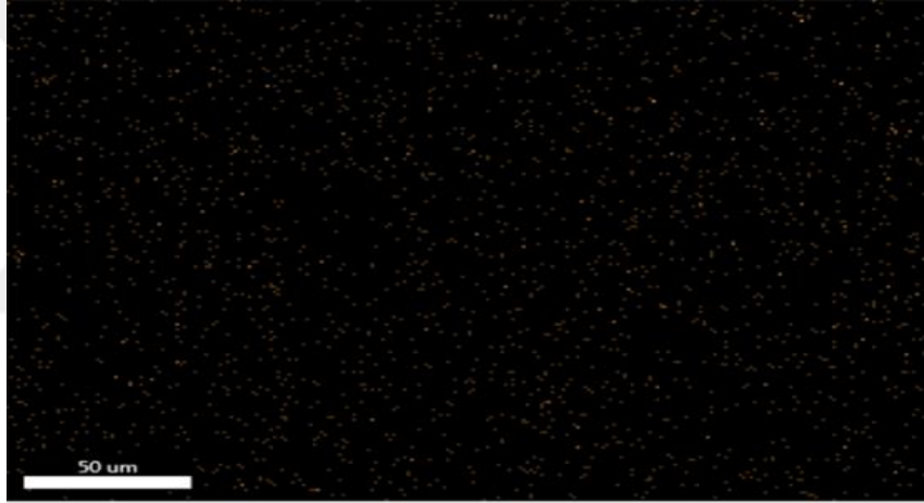
Şekil 4.22: OKN film numunesindeki Na (sodyum) elementinin dağılımı
