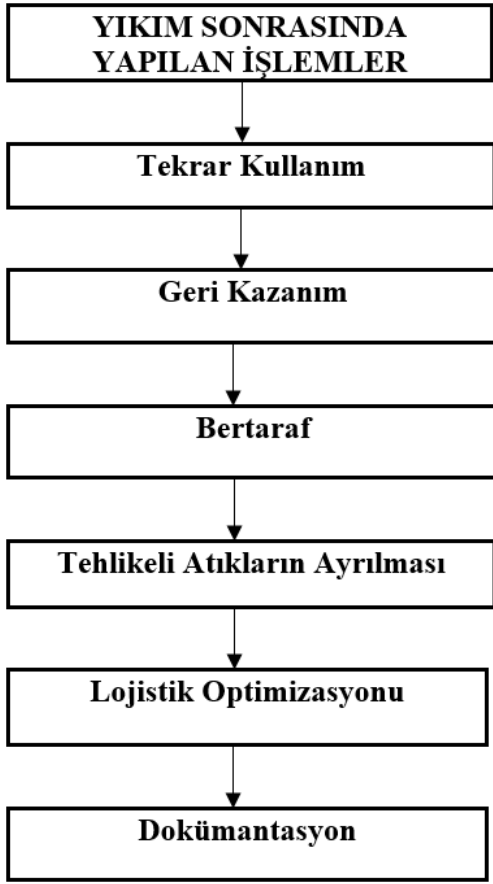
Şekil 4.6: Yıkım Sonrasında Yapılan İşlemler
