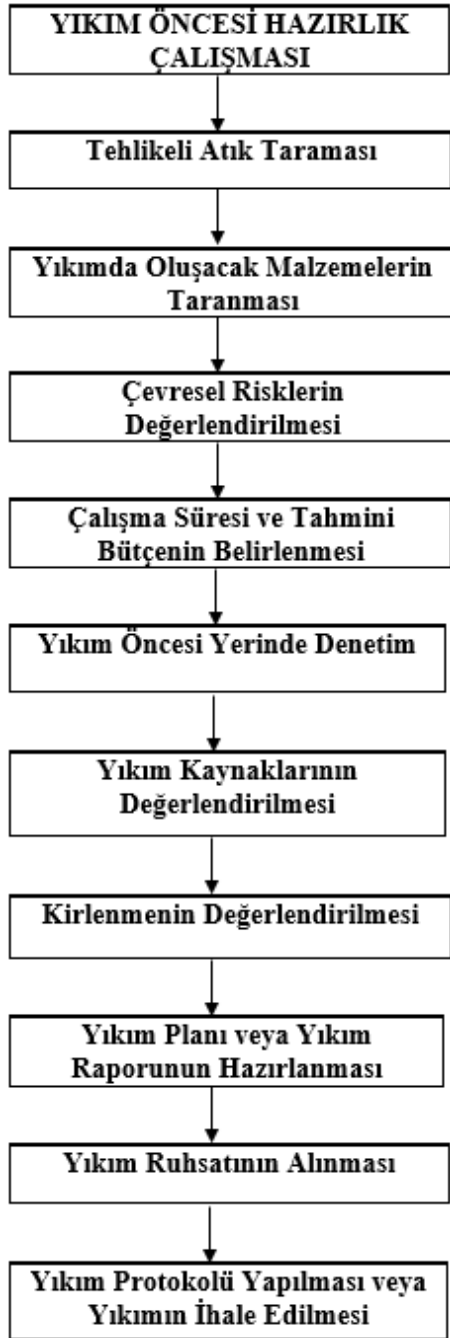
Şekil 4.2: Yıkım Öncesinde Hazırlık Çalışması Süreçleri
