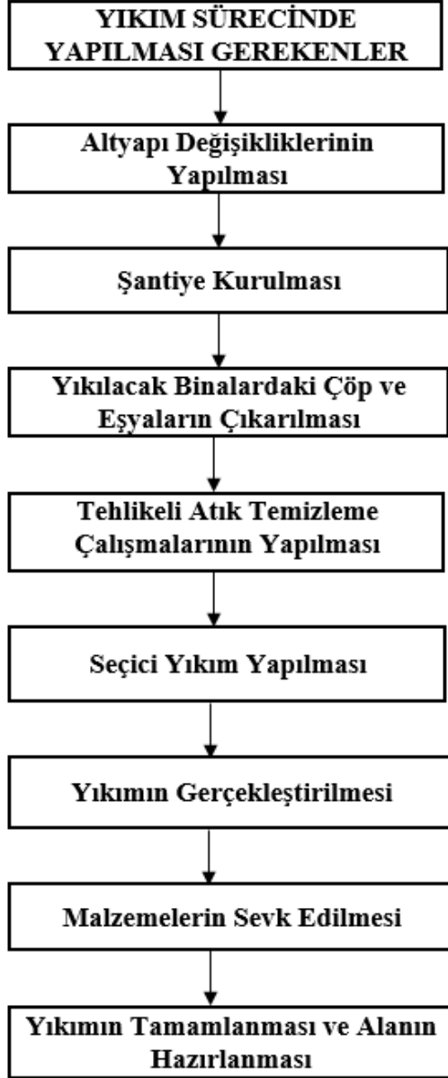
Şekil 4.3: Yıkım Sürecinde Yapılması Gerekenler
