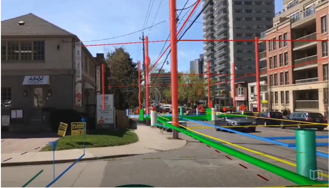
Şekil 4.10: AG yöntemi ile kıymetlendirilen altyapı elemanları
