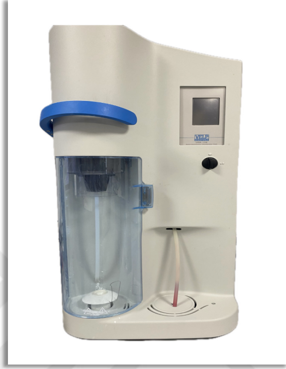
Şekil 3.4: Distilasyon Cihazı- Velp- UDK 139 Yarı Otomatik Kjeldahl Distilasyon Ünitesi, azot protein tayin cihazı
