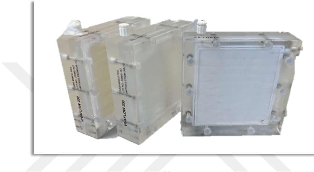
řekil 3.21: MWCO 3,5 ve 10 kDa ultrafiltrasyon membranları
