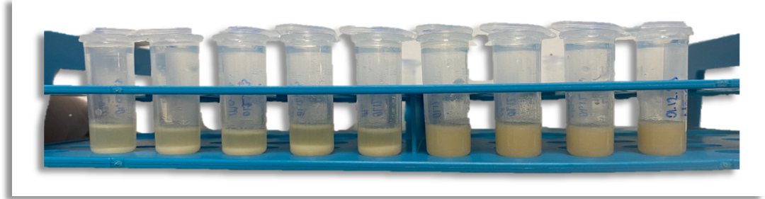
Şekil 3.35: Protein oranı 38 \text{ mg.m}^{-1} , pH 2, 1 saat 37^\circ\text{C} 100 rpm %4 pepsin (mide ortamı) ve pH 7.5, 2 saat 37^\circ\text{C} 100 rpm %4 pankreatin (bağırsak ortamı) içeren üretim günü (0. gün) yoğurt kontrol, (%2-5) APH, KPH ve BPH örneklerinin 180.dk'lık sindirimi ve 5 dk 10.000x g santrifüj sonrası elde edilen süpernatant.
