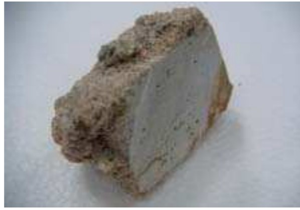
Şekil 4: Aspar Su Sarnıcı derz harcının yapı taşıyla olan ilişkisi.
