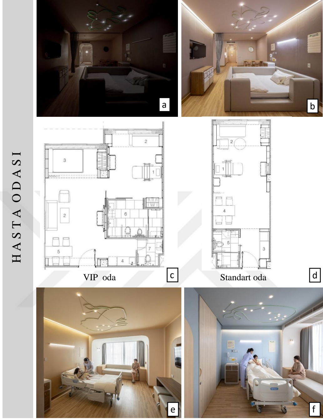
Şekil 4.25: (a,b) Hasta odasında aydınlatma elemanları, (c) VIP oda planı, (d) Standart oda planı, (e,f) Hasta odasının doğal aydınlatması ve ahşap mobilyaları.
