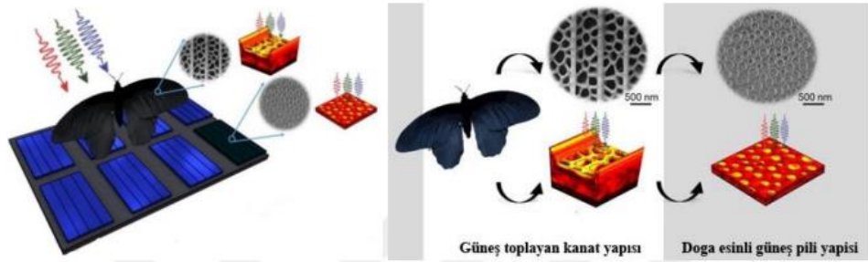
Şekil 3.6: Gül Kelebeğinin Kanadından Esinlenerek Geliştirilen Güneş Pili
