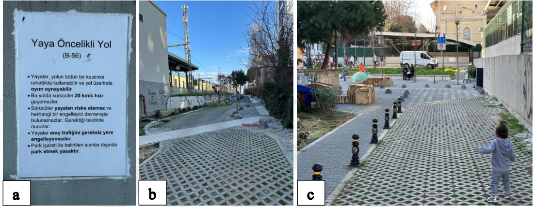
Şekil 4.20: (a) Yaya öncelikli yol kuralları, (b) Sokak Lineerliğini bozan yavaşlatma elemanları, (c) Zemin doku malzemesinde farklılık.
