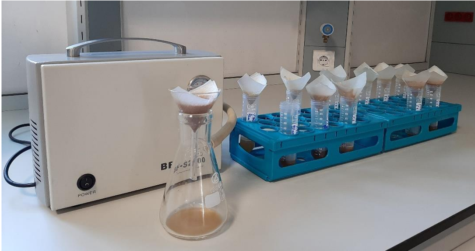
Şekil 16. Sindirilmiş ürünlerin kaba filtreden geçirilmesi
