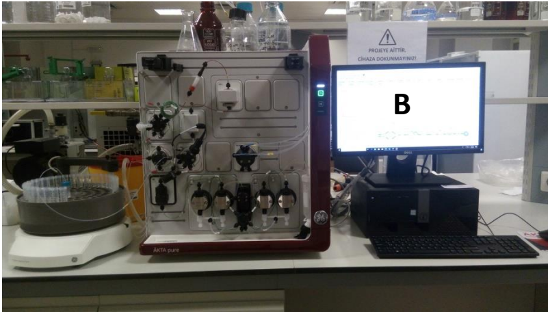
Şekil 7. (A) FPLC'de fraksiyonları için kurulan örnek metot, (B) FPLC'de hidrolizatların düzenlenen metot ile fraksiyonlanması.
