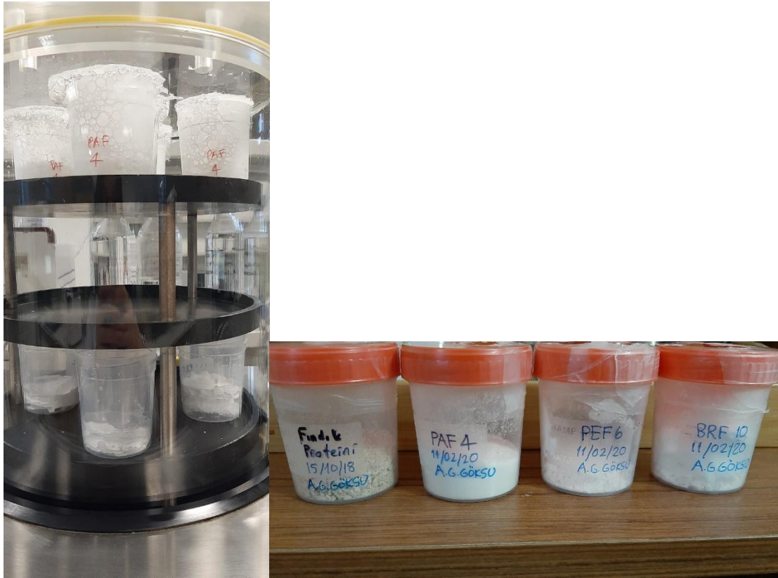
Şekil 8. FİSKOBİRLİK tesislerinde değerlendirilen örneklerin liyofilize edilmesi.
