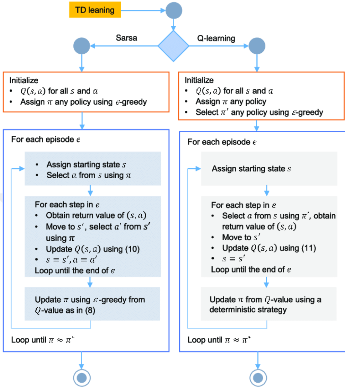
Şekil 3.9: Q- öğrenme ve SARSA Adımlarının Karşılaştırılması
