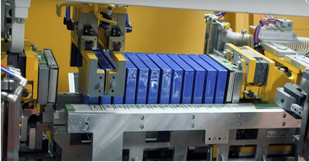
Şekil 6. Hücrelerin istiflenmesi ve sıkıştırılması (KUKA, 2021)
