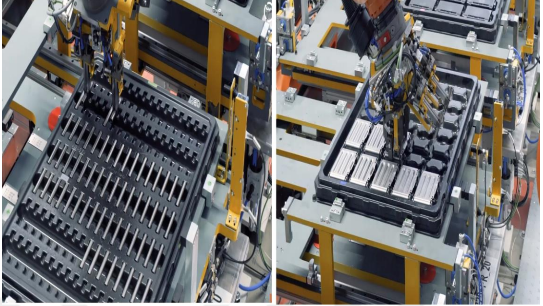
Şekil 5. Basınç plakaları ve bağlantı çubuklarının hazırlanması (KUKA, 2021)
