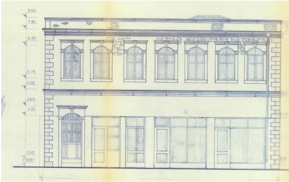
Şekil 5.7: 273 ada 7 parseldeki yapının 1982'deki cephe rölövesi
