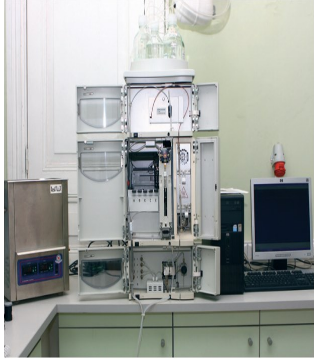
Şekil 2.9: HPLC cihazını oluşturan birimlerin açık görünümü
