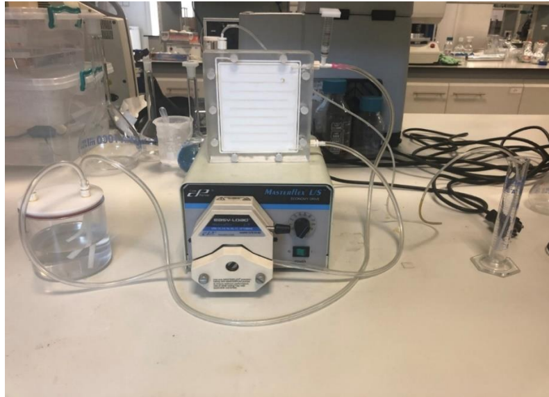
Şekil 3.4. Cole-Parmer Masterflex L/S Easy-Load marka ultrafiltrasyon sistemi
