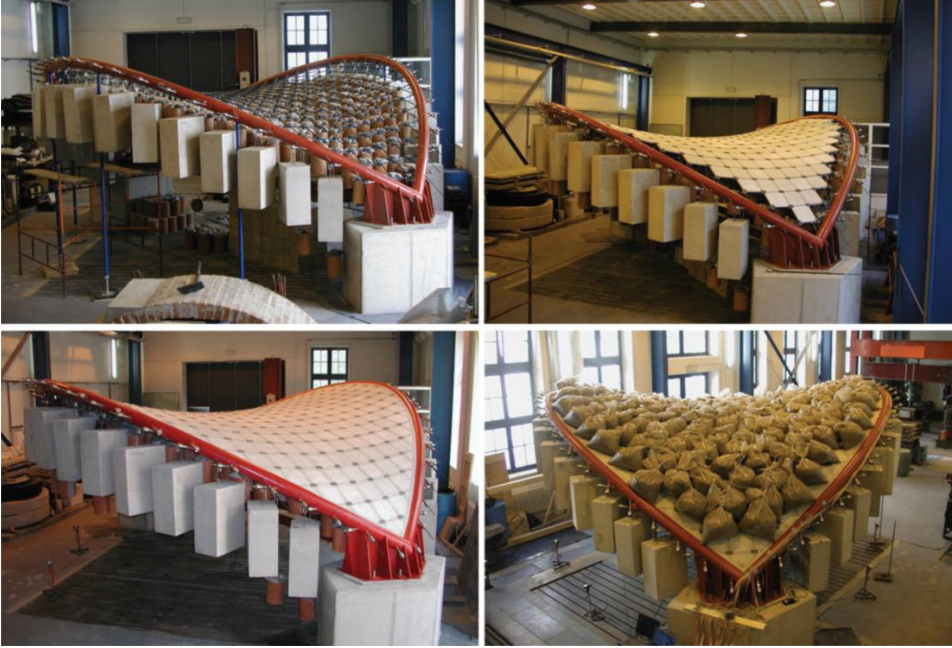
Şekil: 4 1/10 ölçeğindeki prototip ve deneyin oluşum aşamaları (Strasky ve diğerleri 2017, 5-18).
