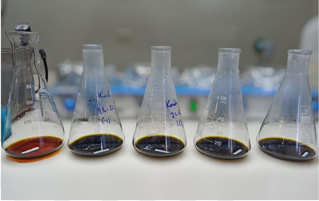
Şekil 3.9: Organik karbon analizi potasyum dikromat eklenmesi sonrası gösterimi
