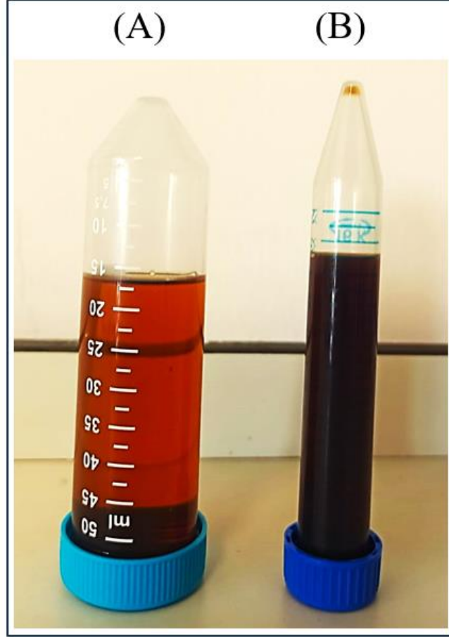
Şekil 4.7: Optimize edilerek elde edilen kanola proteini hidrolizatı (A) ve optimize protein hidrolizatının evaporasyon ile konsantre edilmiş formu (B)
