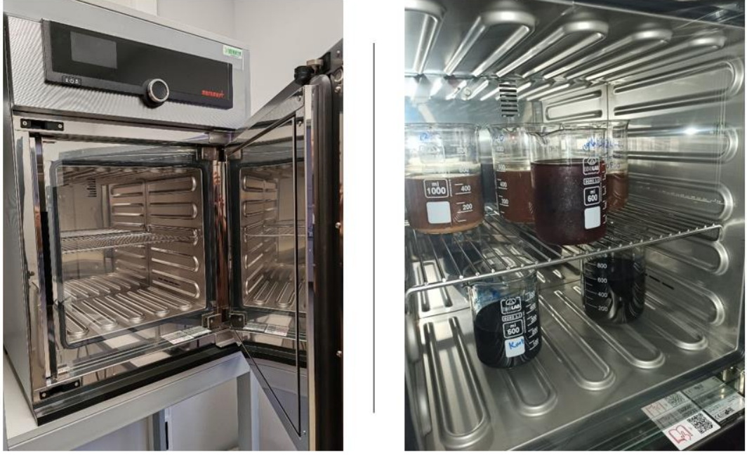
Şekil 3.6: Hidrolizat numunelerinin konsantre edildiđi etüv ve numunelerin gösterimi
