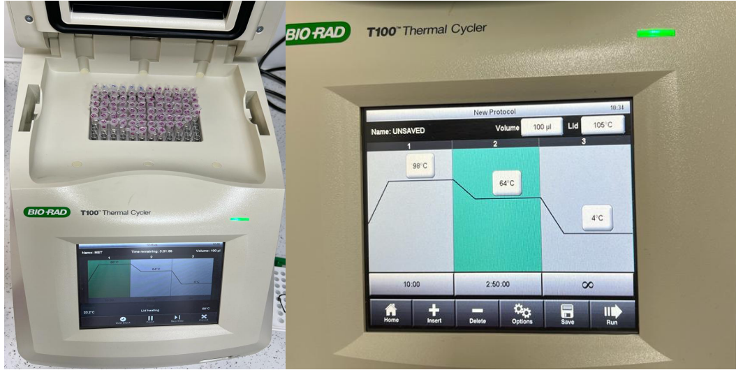
Şekil 3.2. Bisülfid Modifikasyonunda Termal Döngü Cihazı ve Adımları
