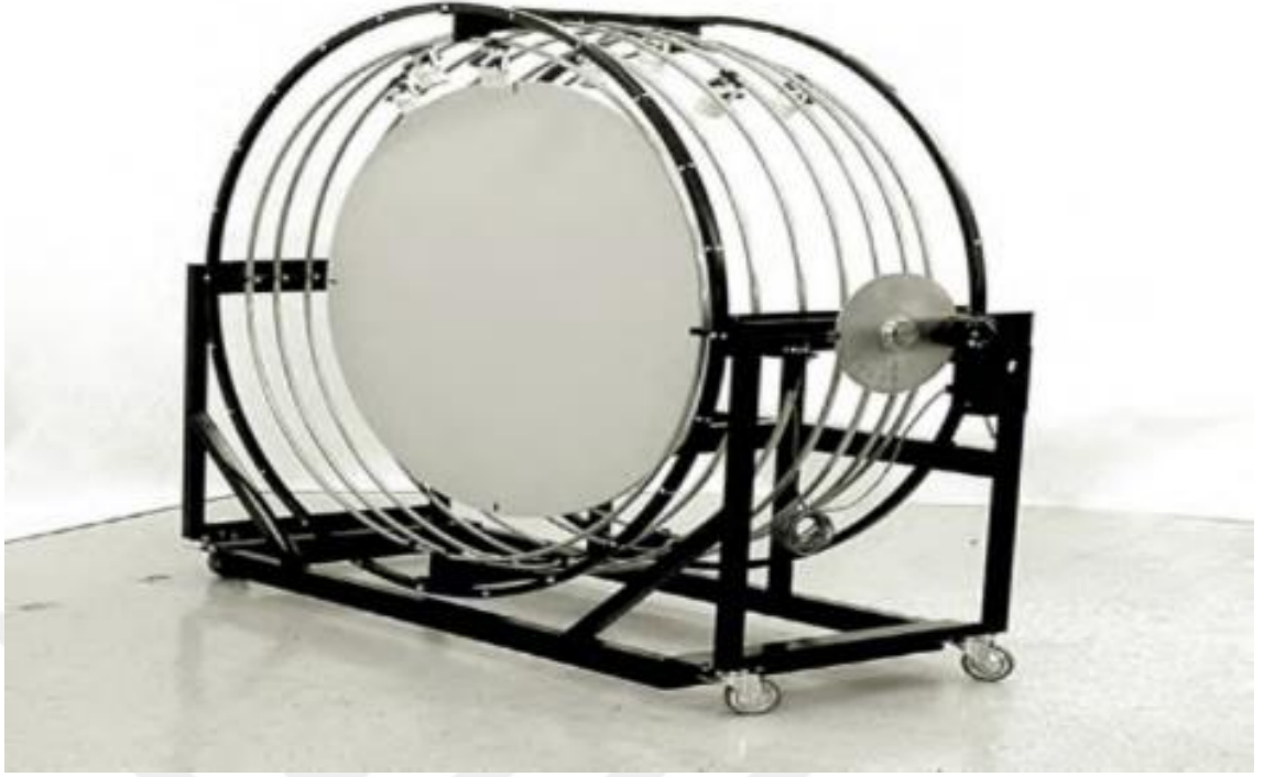
Şekil 3.8: Lancher tarafından geliştirilen heliodon modeli
