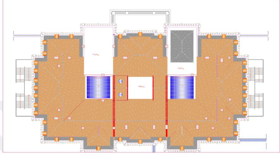
Şekil 2.20 Çatı Planı Restitüsyon Çalışması (Kaynak:Dor İnşaat Ltd. Şti.)
