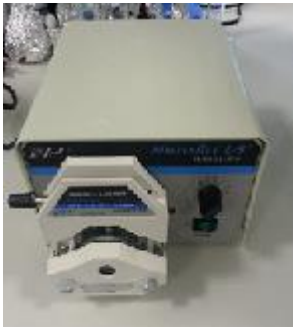
Şekil 1. Ultrafiltrasyon cihazı (Sartorius Masterflex Ultrafiltration System).
