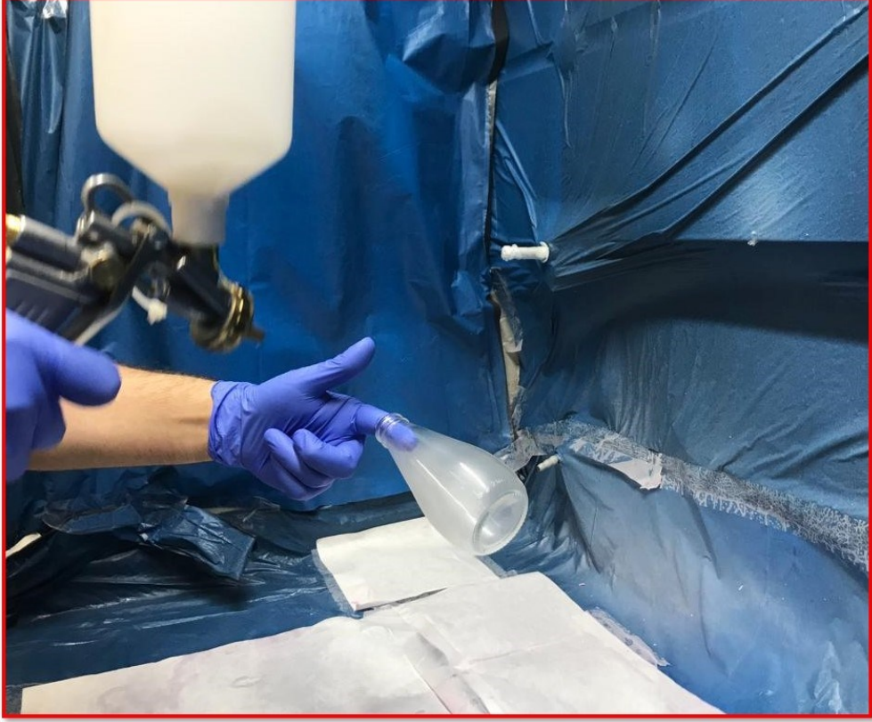
Şekil 3.9: Sentezlenen inorganik-organik hibrit kaplamanın cam şişe yüzeyine spreylendirme yöntemi ile uygulanması
