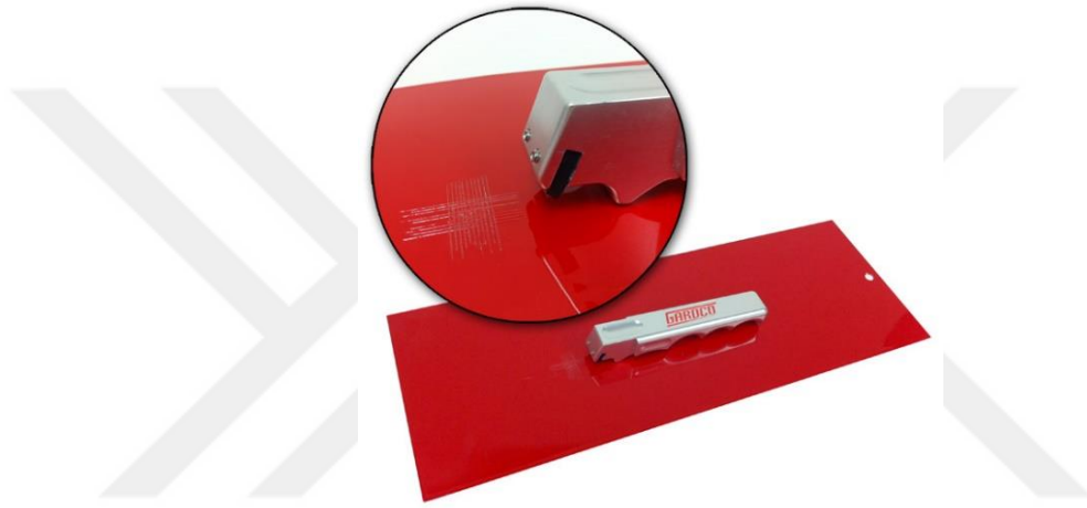
Şekil 4.53: Kaplamalarda çizme-tutunma testinin yüzeye uygulanması
