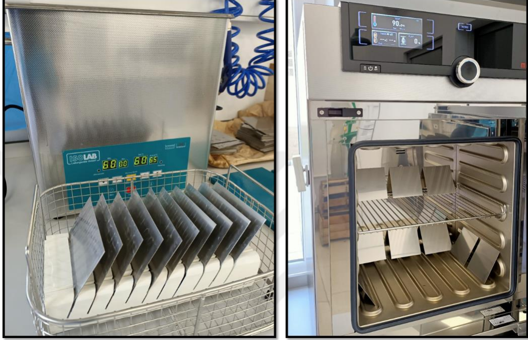
Şekil 3.3: Plakaların ultrasonik banyoda yıkama ve etüvde kurutma işlemi
