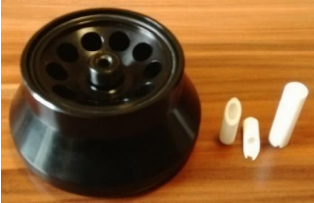
Şekil 18. 3 boyutlu yazıcı ile üretilmiş örnek tutucu tüpler (üstte 50 mL hacimdeki tüpler ve altta 5 mL hacimdeki tüpler)
