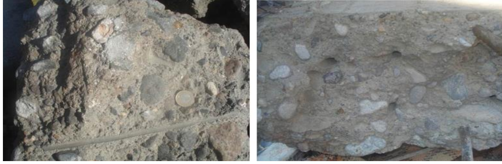
Şekil 7.78: Van Erciş yapılardan alınan beton kesit örnekleri
