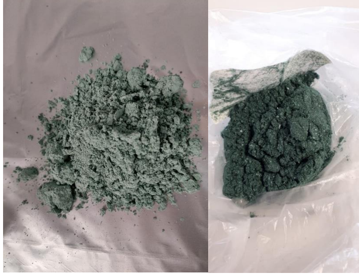
Şekil.4.1: Spray Dryer ile Elde Edilen Protein (sol) ve Liyofilizasyon ile Elde Edilen Protein Arasındaki Renk Farkı(sağ)
