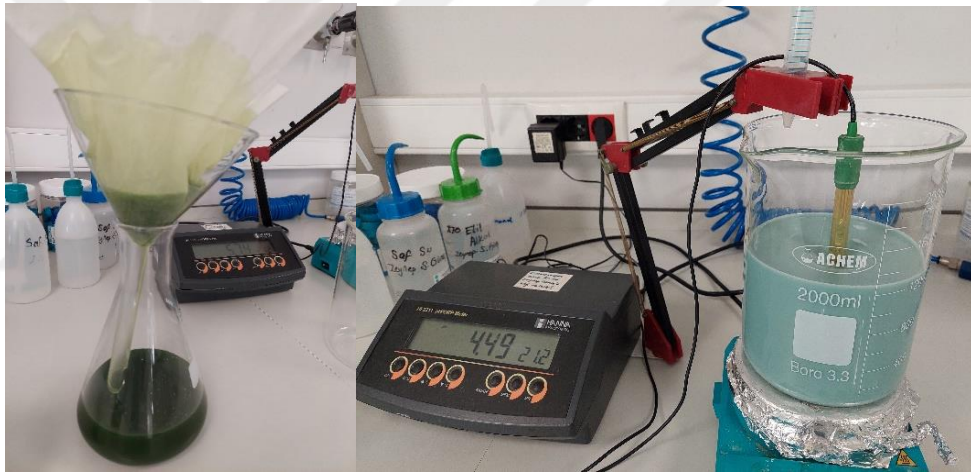
Şekil 3.4: Süpernatantın Filtre Kağıdından Geçirilmesi (sol) ve pH:4,5 'da Çökeltmenin Teşvik Edilmesi (sağ)
