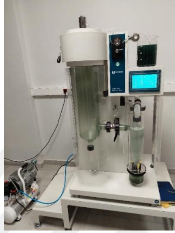
Şekil 3.7: Çalışmada Kullanılan Unopex B 15 Mini Spray Dryer (TR)
