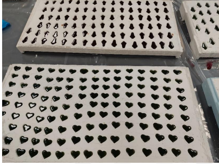
Şekil.3.20: Yumuşak Şekerlemelerin 48 Saat Oda Sıcaklığında Dinlendirilmesi
