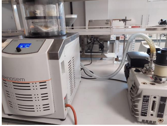
Şekil.2.2: Protein İzolatlarının Kurutulmasında Kullanılan Liyofilizatör (Toros2/2 V)
