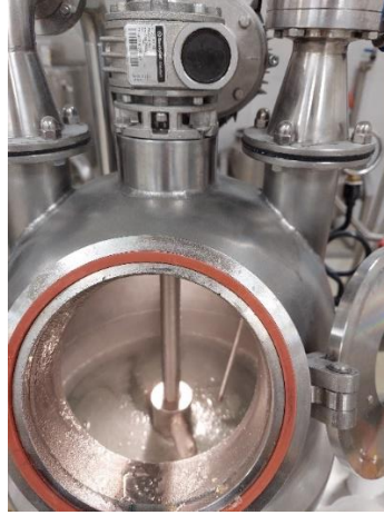
Şekil.3.15: Khandaby Laboratory Bach Cooker ile Şekerleme Hamurunun Karıştırılması
