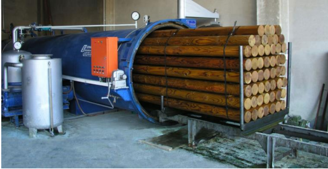
Şekil 4.50: Emprenye tankı ile yüksek basınç altında daldırılarak ahşabın iç kısımlarına emdirilmesi
