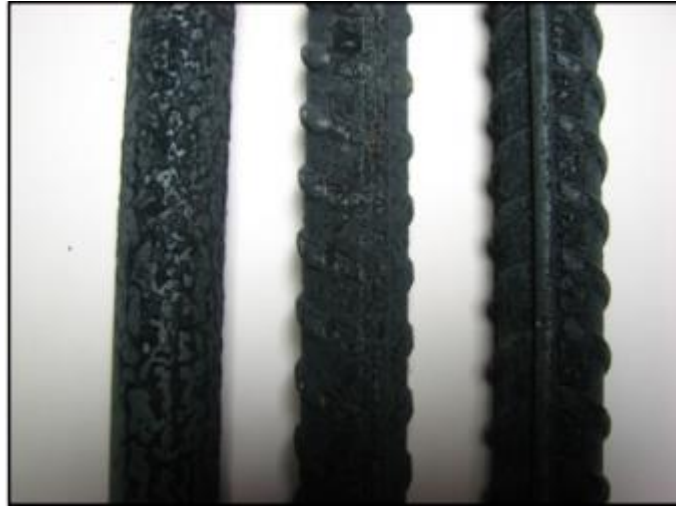
Şekil 4.36: Yüksek sıcaklıkta betonarme donatı çeliği örnekleri
