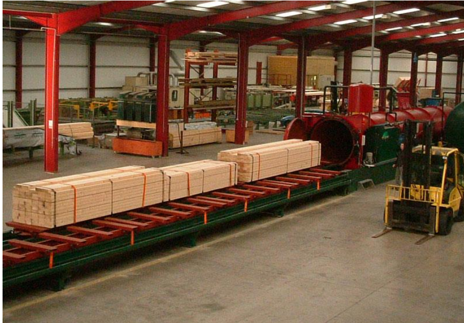
Şekil 4.52: Ahşap elemanlara emprenye tankı uygulanması
