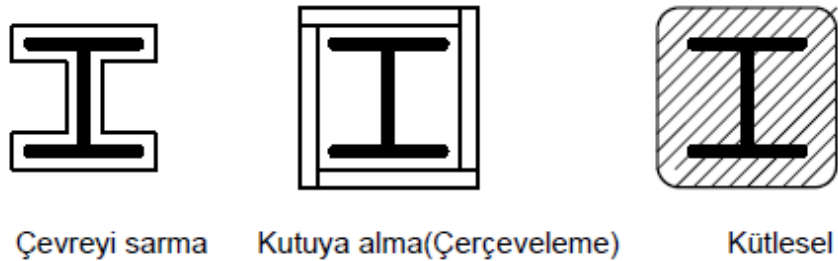
Şekil 4.13: Çelik yapı elemanlarına uygulanan yalıtım türleri
