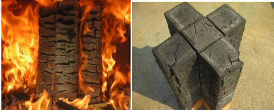
Şekil 4.47: Ahşabın yanma anında kömürleşmesi ve sonlanması
